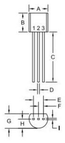
**INCHES** MIN SYMBOL MIN MAX MAX A (DIA) 0.175 0.170 0.210 0,500 C 0.016 0.022 0.56 D 0.41 E 0.100 2.54 0.050 F G 0.125 0.165 4.19 0.080 0.105 0.015 0.38 TO-92 (REV: R1)
